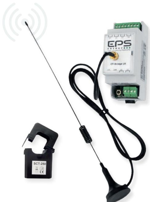
Die **CT-Bridge** ist für den Einsatz in Kabelverteilerschränken und Ortsnetzstationen entwickelt. Sie arbeitet mit Energie-Harvesting und benötigt keine externe Spannungsversorgung.
